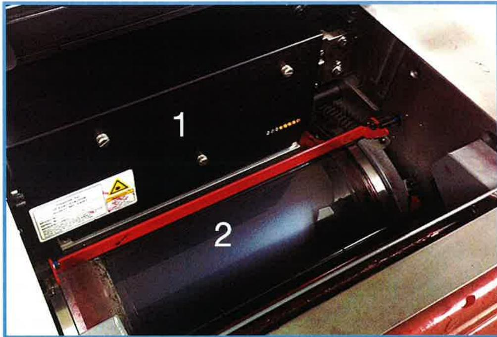
1.-Cabezales láser. 2.-Plancha de impresión virgen
